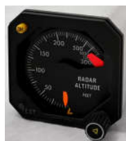
无线电高度表：真实高度
